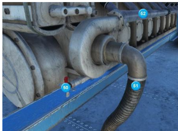
50. Vidange eau droite 51. Arrivée eau droite 52. Distributeur eau droite
