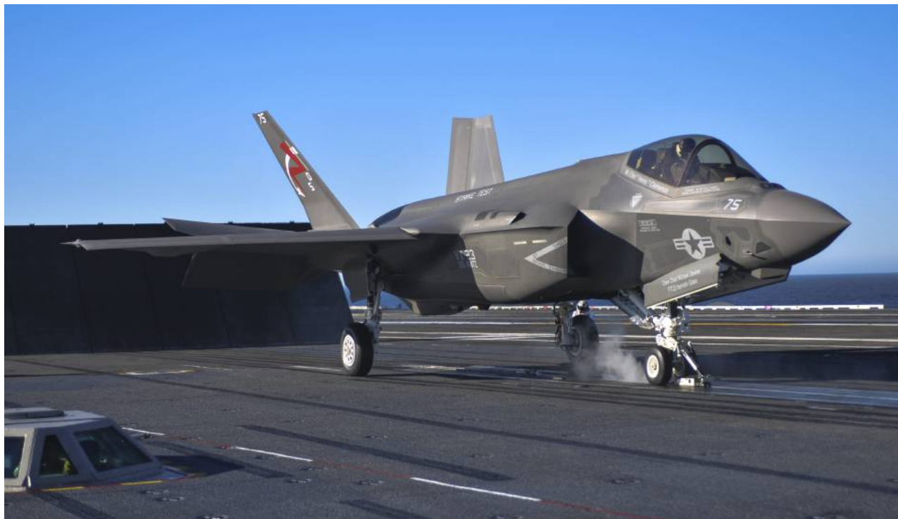
Le F-35C se prépare à décoller à l'aide d'une catapulte depuis un porte-avions de classe USS Nimitz
