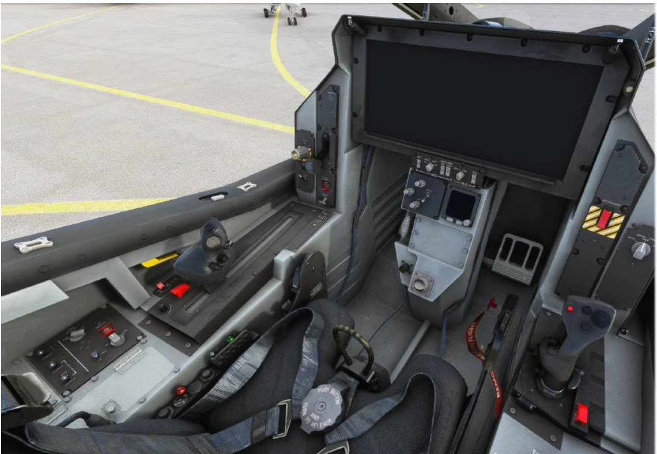
VUE GÉNÉRALE DU COCKPIT – la disposition du cockpit est identique pour les variantes -A, -B et -C. La géométrie du cockpit de la variante -B est légèrement différente, avec une visibilité arrière plus faible, pour faire de la place à l'admission du système Lift-Fan.
