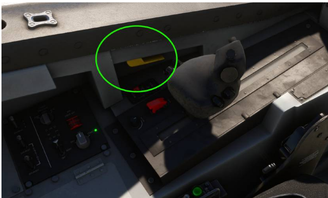
Emplacement du levier de commande de la verrière – REMARQUE : dans l'avion réel, il s'agit du levier de VERROUILLAGE de la verrière : un « UP- L'interrupteur « DOWN » est situé à proximité.
