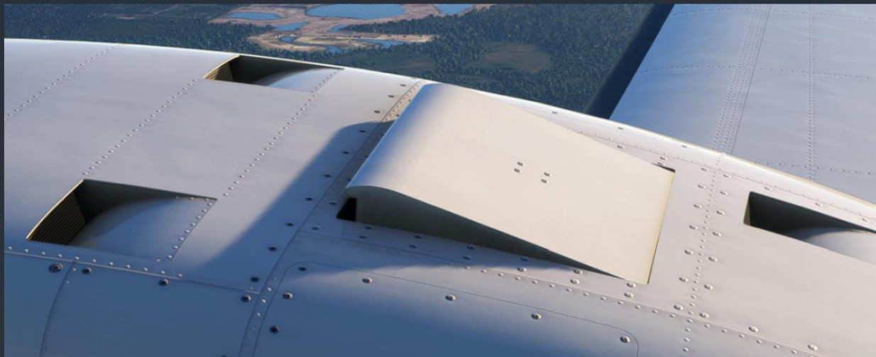
Ci-dessus : porte de pressurisation de l'échangeur de chaleur, partiellement ouverte - position de vol
