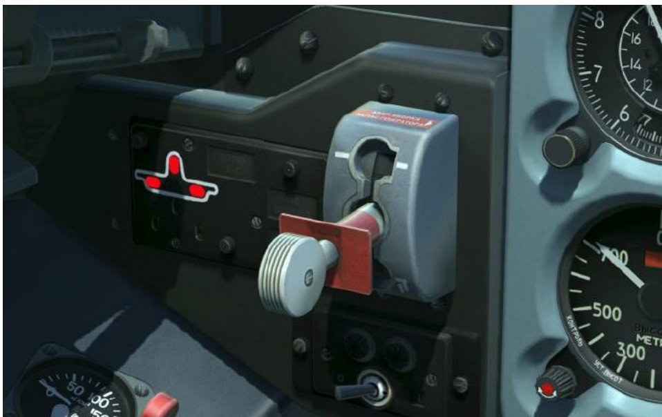
Figure 45 : Levier de commandes des trains, habitacle arrière
