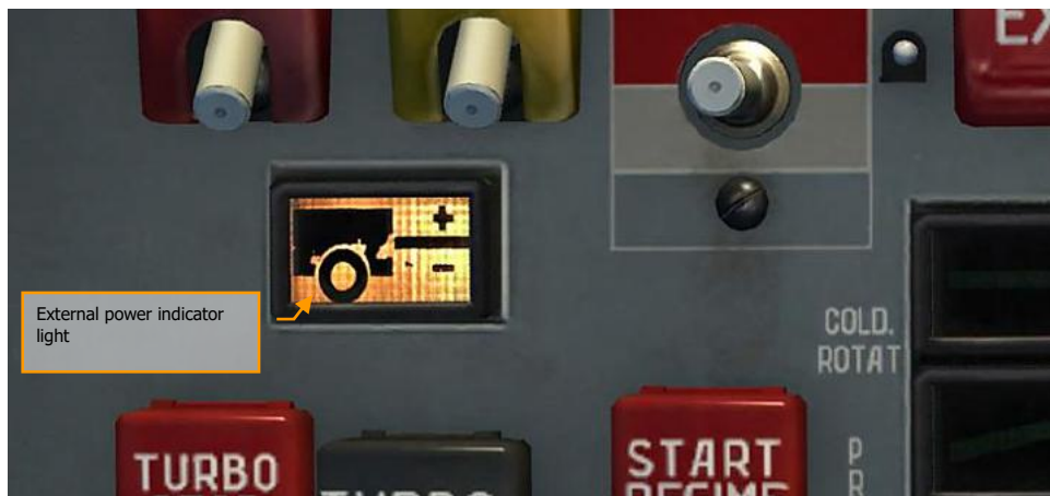
Figure 87 : Voyant de source de puissance extérieure
