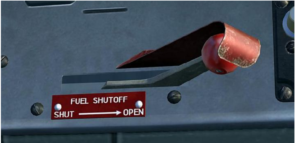
Figure 64 : Vanne de coupure de carburant des deux habitacles
