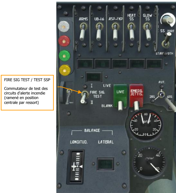
Figure 67 : Commutateur de test du circuit d'alerte incendie
