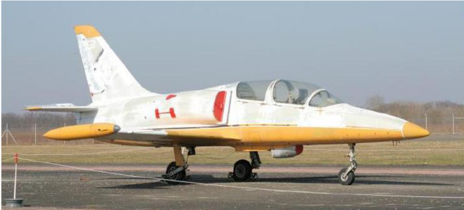
Figure 11 : L-39V (Vlečná - remorqueur) – Monoplace KT-04 remorqueur de cible
