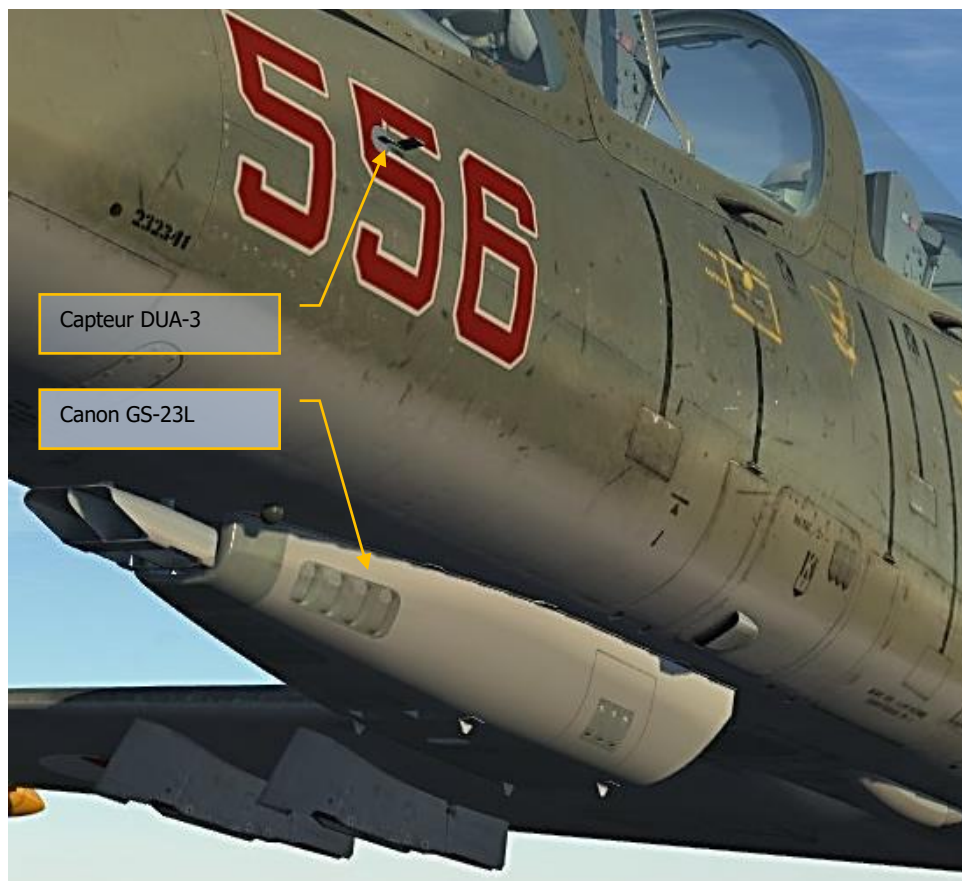
Figure 165: Canon et capteur d'incidence du L-39ZA
