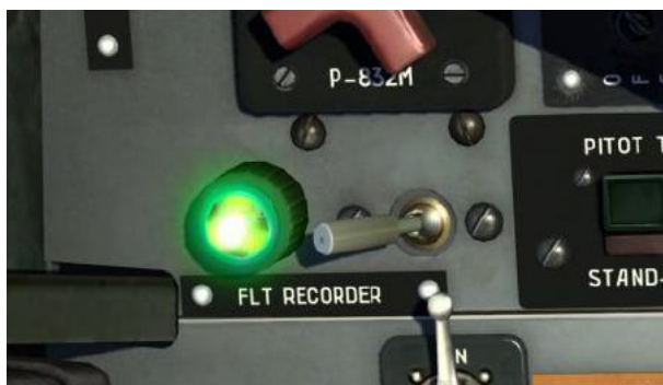
Figure 127: Commandes de l'enregistreur de vol sarpp-12GM
