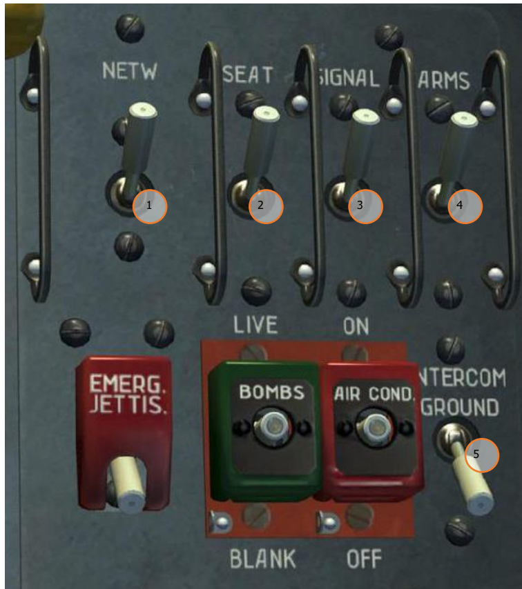
Figure 86 : Panneau électrique des disjoncteurs de l'habitacle arrière
