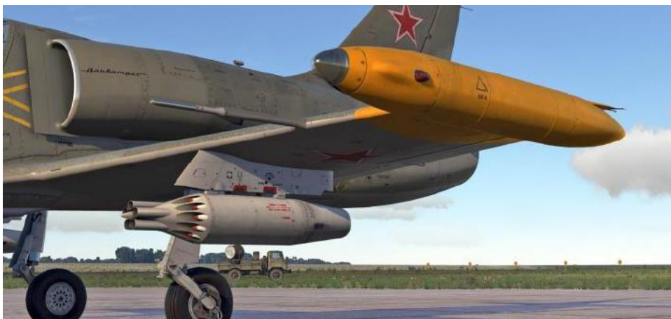
Figure 38 : Pylône, tube Pitot et réservoir d'extrémité d'aile.
