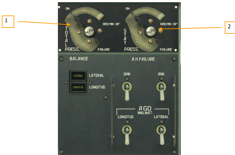
Figure 108 : Panneau de simulation de pannes de l'habitacle avant.
