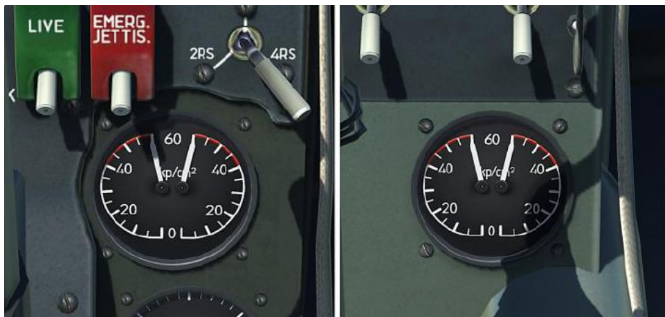
Figure 47 : Manomètre à double aiguille dans les habitacles avant (à gauche) et arrière (à droite)
