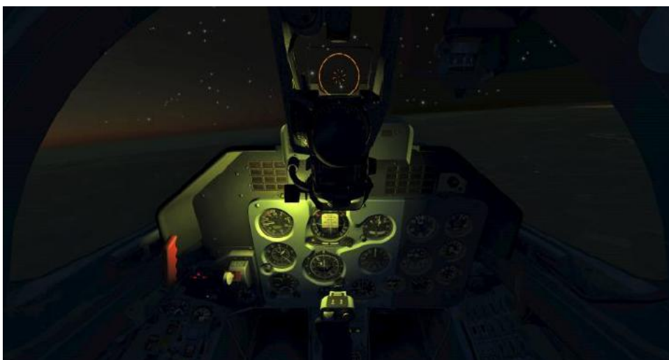
Figure 94 : Habitacle avec éclairage de secours du tableau de bord activé
