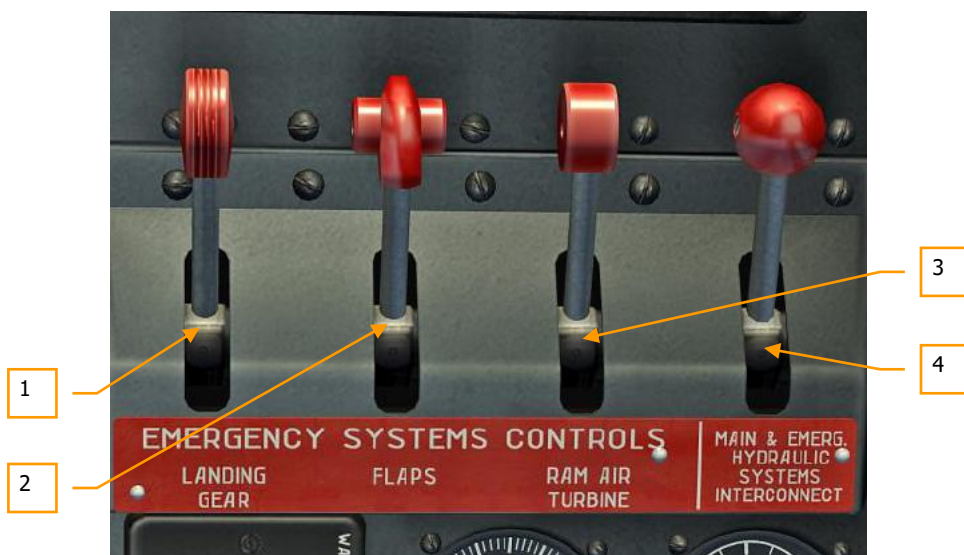
Figure 53 : Vannes du système hydraulique de secours.
