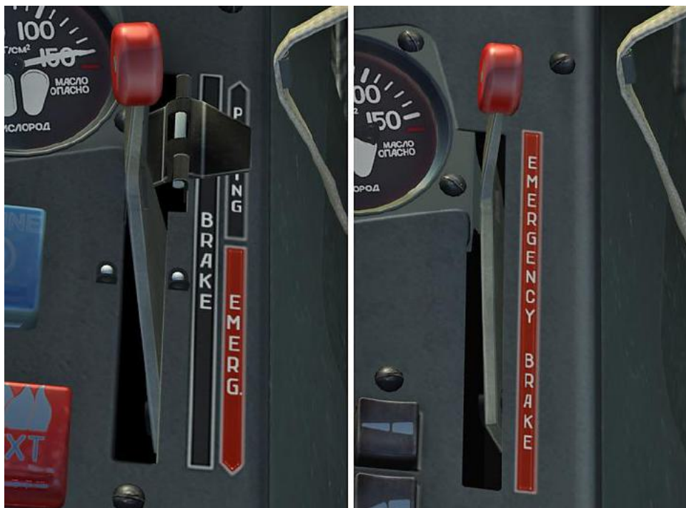
Figure 55 : Leviers de freinage d'urgence dans les habitacles avant (gauche) et arrière (droite)
