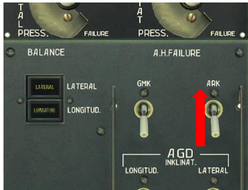
Figure 134: Interrupteur de simulation de panne du RKL-41
