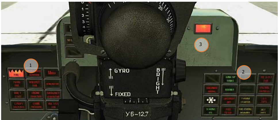
Figure 95 : panneau des voyants d'alerte, de signalisation et d'avertissement de l'habitacle avant
