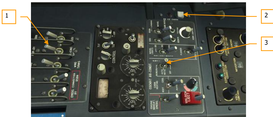
Figure 70 : Commande du système de dégivrage
