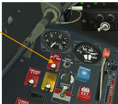
Interrupteur d'arrêt manuel du régulateur RT-12 JPT
