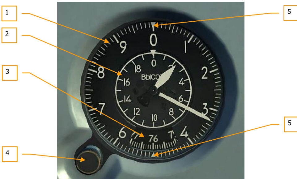
Figure 109: Altimètre barométrique VD-20,
