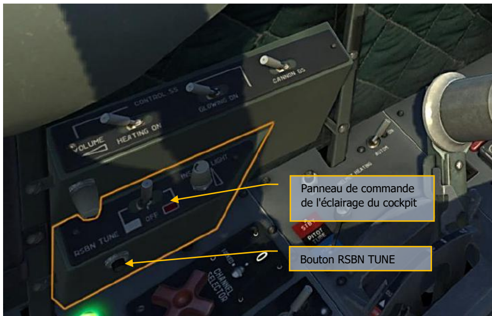
Figure 168: Commandes de l'éclairage habitacle et bouton RSBN TUNE
