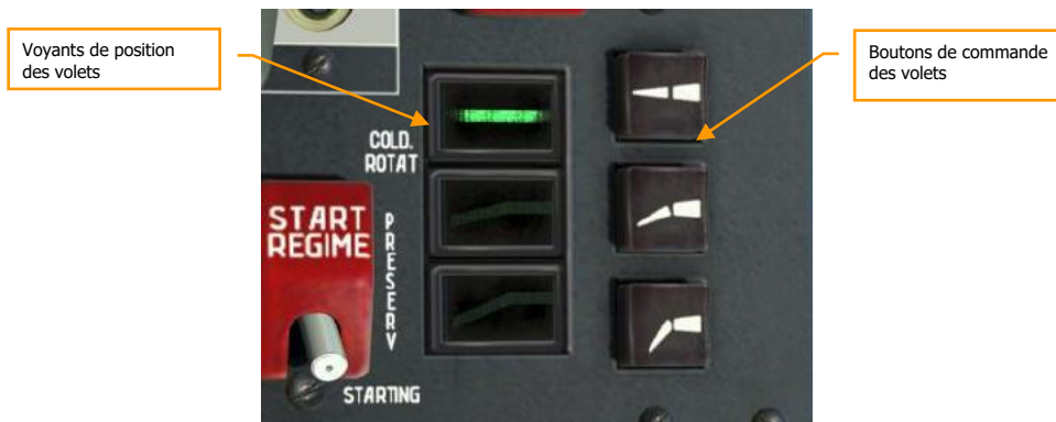
Figure 48 : Indicateurs de position et boutons de commande des volets
