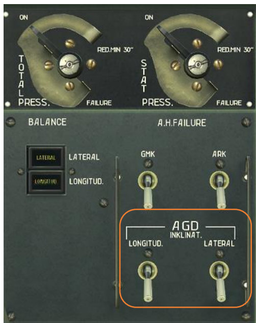
Figure 114 : Commande de simulation de panne de l'ADI
