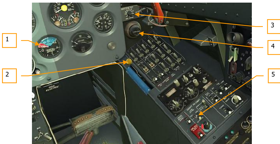
Figure 61 : Commande et signalisation des systèmes de contrôle d'air et d'environnement dans l'habitacle avant
