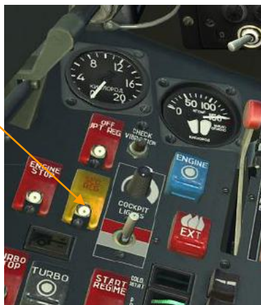
Figure 73 : Interrupteur de secours carburant
