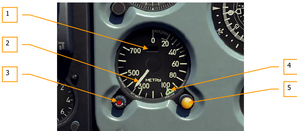
Figure 140 : Altimètre radar basse altitude RV-5
