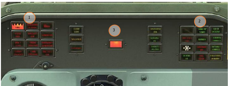
Figure 96 : panneau des voyants d'alerte, de signalisation et d'avertissement de l'habitacle avant
