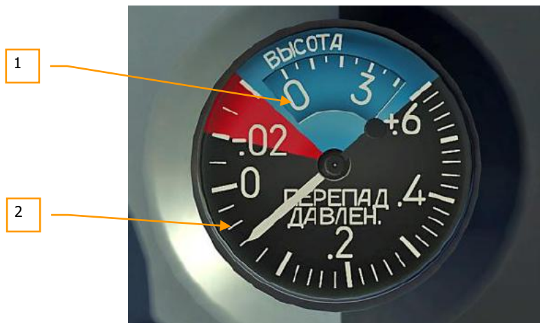
Figure 110 : Jauge de pression différentielle et d'altitude habitacle UVPD.
