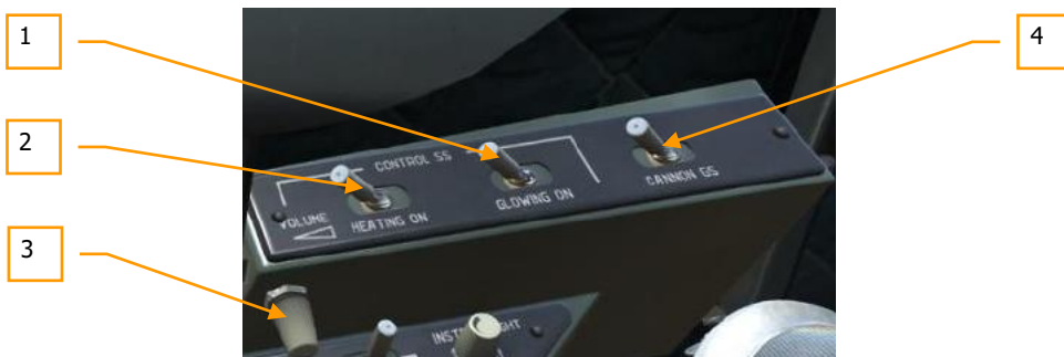
Figure 184 : Panneau de commande R-3S, R-60 et GS-23
