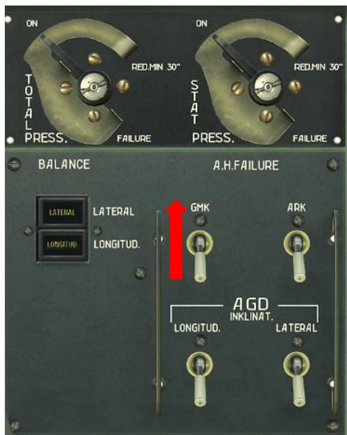
Figure 123: Commande de simulation de panne du GMK-1AE
