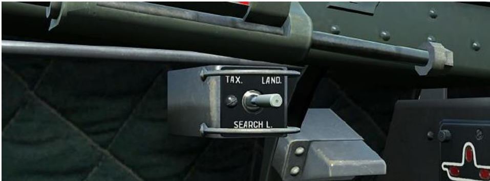
Figure 90 : Interrupteur de commande des phares de roulage et d'atterrissage.
