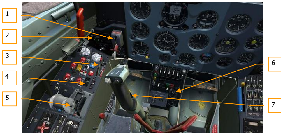
Figure 50 : Commandes et signalisation du système hydraulique des servitudes de l'habitacle avant
