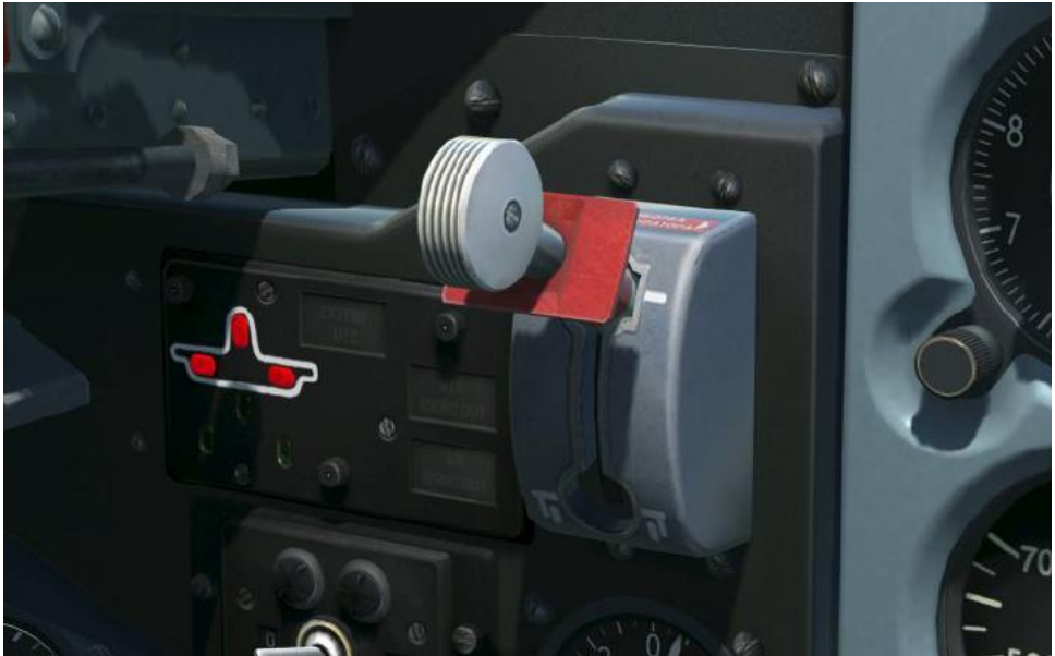
Figure 45 : Levier de commandes des trains, habitacle avant
