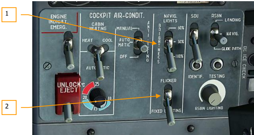
Figure 89 : Commande des feux de navigation
