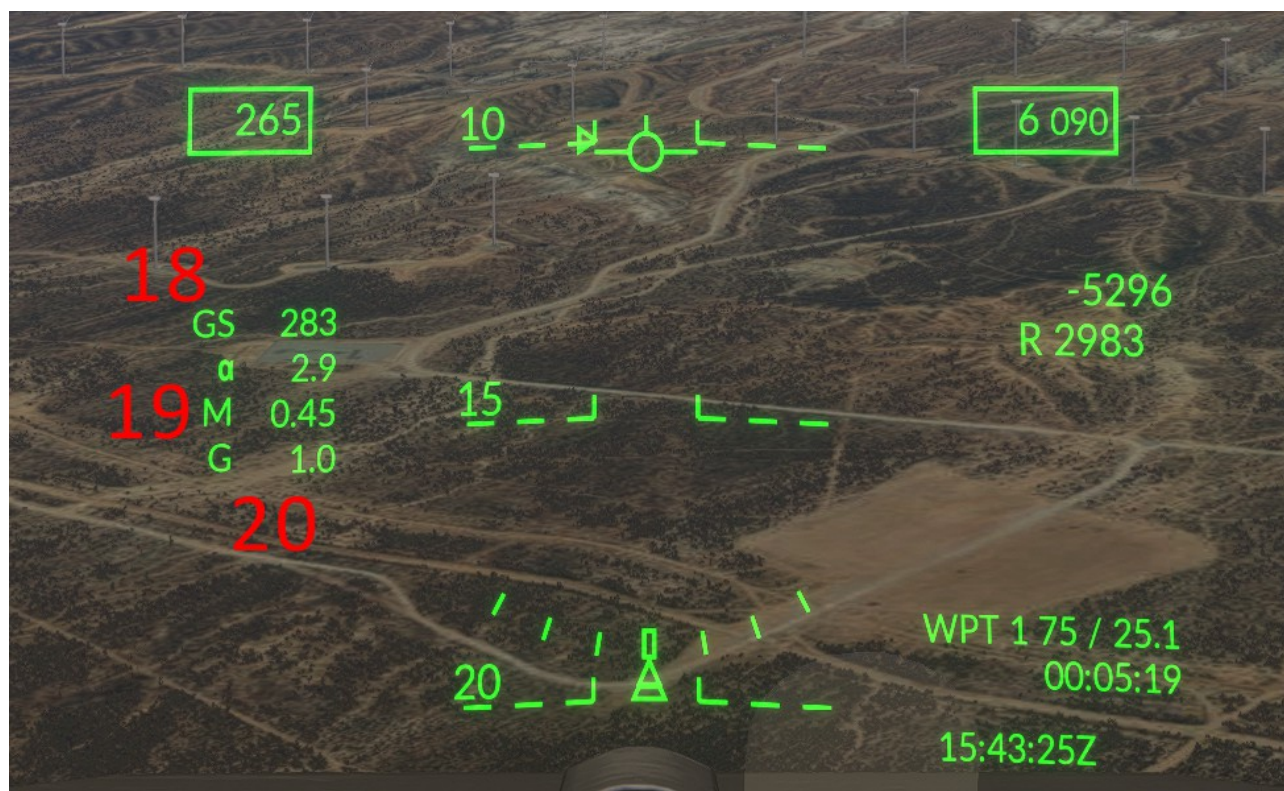
Symbologie VHUD (sur l'axe) – train d'atterrissage rentré
