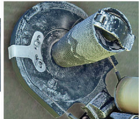
La manette de puissance fait office de poignée pour régler les distances avec câbles relié au tambour des distances du viseur
