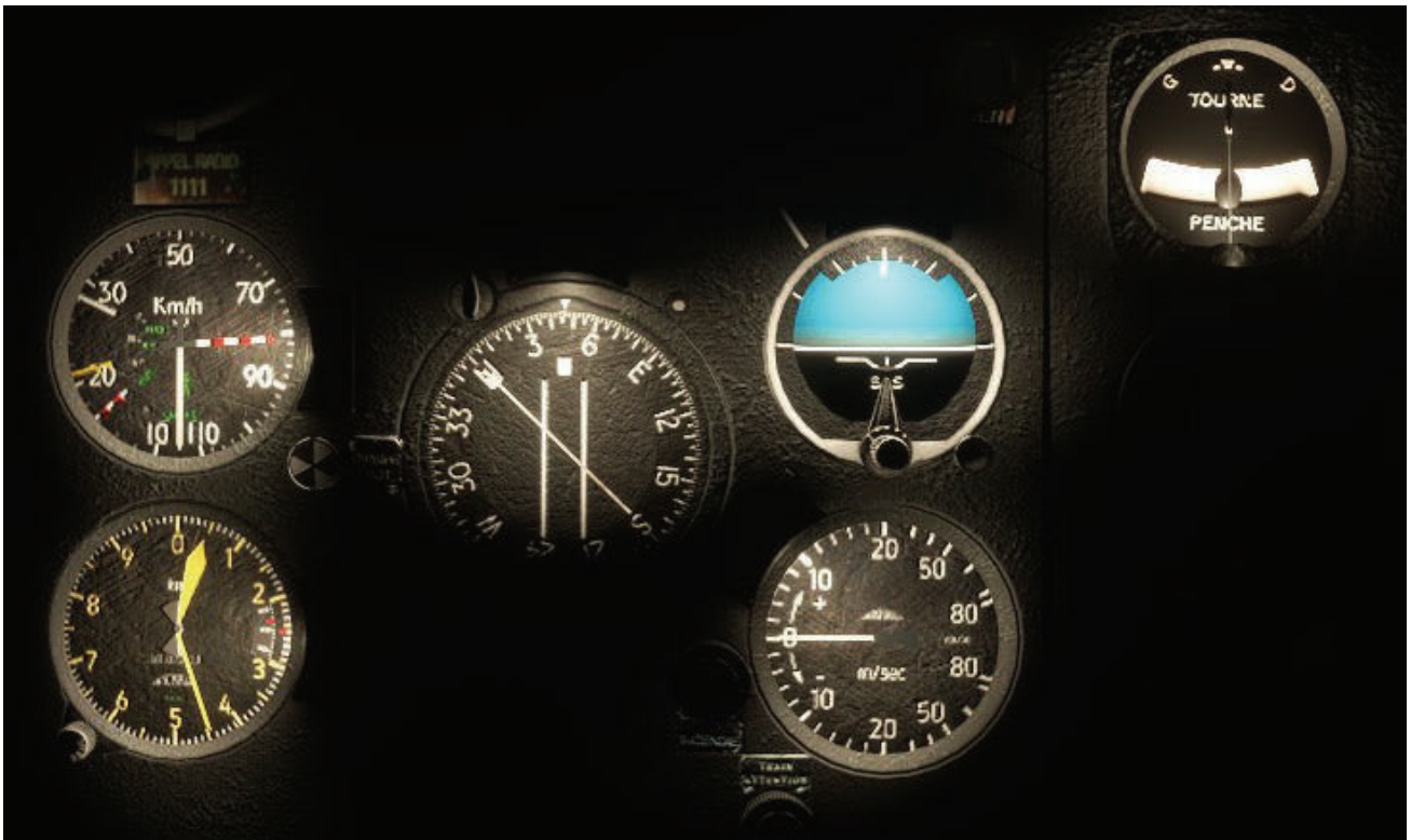
Eclairage normal des instruments par lampe sur le côté de l'instrument
