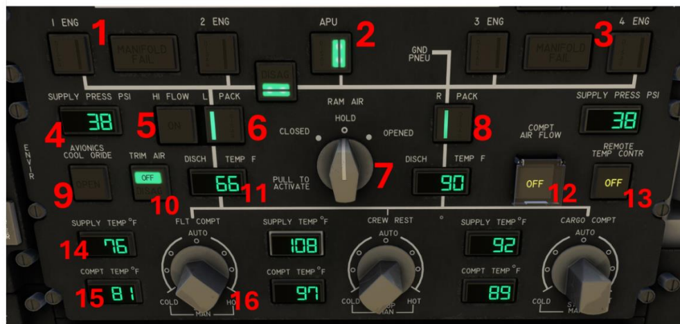
Bleed Air Supply / Air Con Panel
