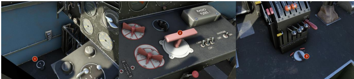
Figure 9-1: Trim controls. (1) Aileron trim. (2) Elevator trim. (3) Rudder trim.
